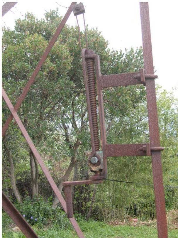
Il marchingegno per l'arresto dell'aeromotore
