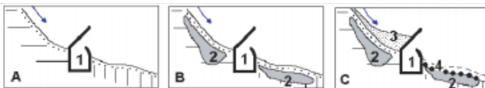
FIG. 1.2.7 Schéma classique des effets d'un aménagement portuaire et d'une multiplication des constructions à très peu de distance du rivage sur l'évolution de la plage dans une côte à dérive littorale active (indiquée par la flèche) portant vers une direction préférentielle: (1) port; (2) constructions; (3) plage élargie; (4) plage érodée (le trait discontinu indique l'ancienne position du rivage); (4) travaux de protection
